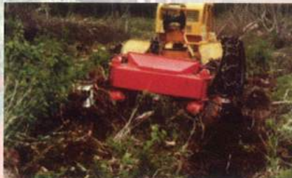
Préparation du sol effectuée par un scarificateur à disques. Source: OPBRQ
