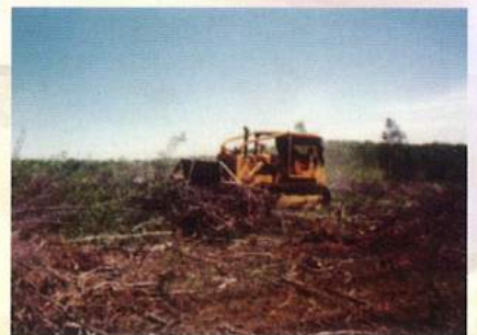
La mise en andains des déchets de coupe facilite le reboisement. Source: SPBM
